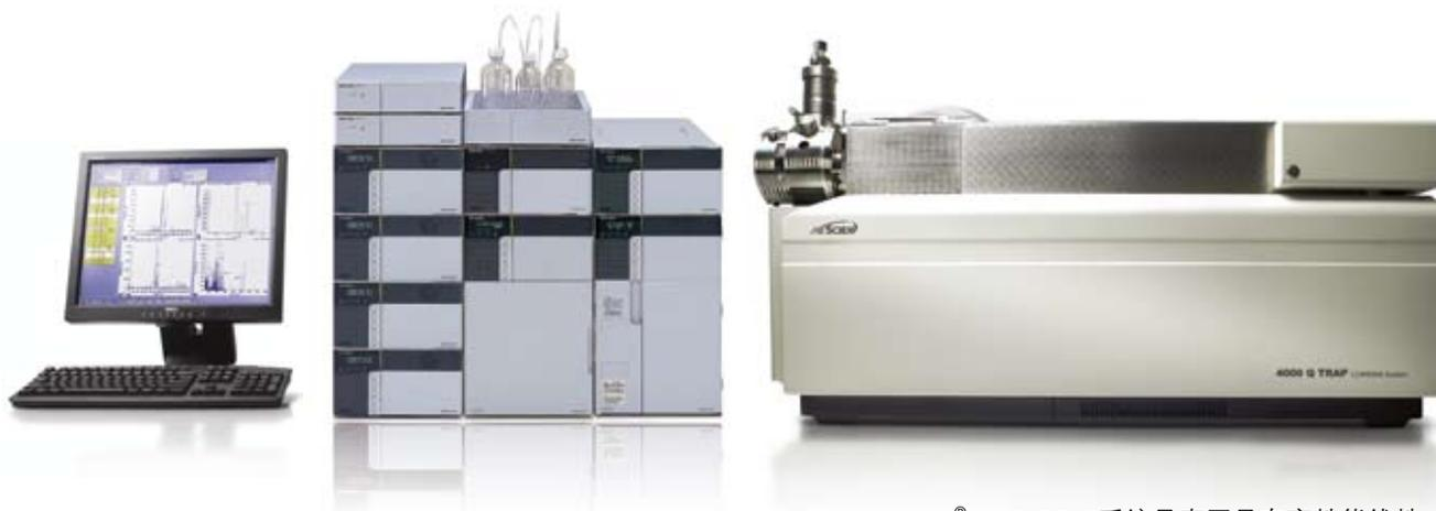
4000 Q TRAP<sup>®</sup> LC/MS/MS系统是真正具有高性能线性离子阱扫描功能和串联四极杆高灵敏度性能的系统
