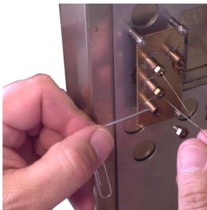
多次断开和重新连接之后，SilTite 密封垫圈密封性仍然应该很好。
