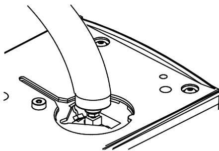
如果传输线来自 G1900A 吹扫捕集单元，则应在加热线组件金属套管上方和内部安装传输线支持螺母组件，以免损坏熔融石英管线。
