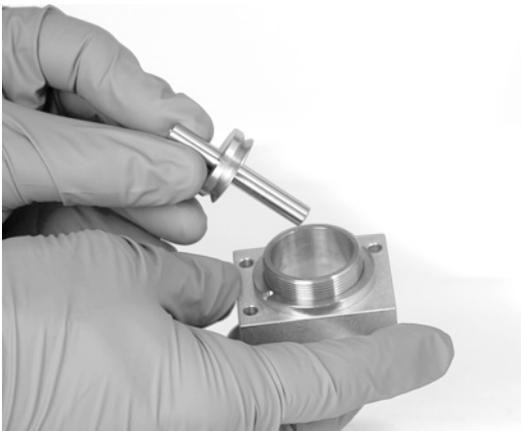
c 将另一个绝热体插到收集极上，绝热体平的一面朝着外壳。
