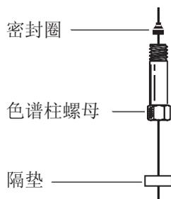
6 用玻璃划针盘在色谱柱上刻线。刻线必须同色谱柱垂直以确保断面整齐。
