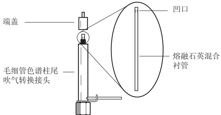
10 在尾吹气转接头上放置一个 1/4 英寸 Swagelok 螺母和密封垫圈。
