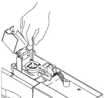
20 安装“O”形金属圈（下）、陶瓷绝缘体（下）和“O”形金属圈（上）。请参阅图 5。
