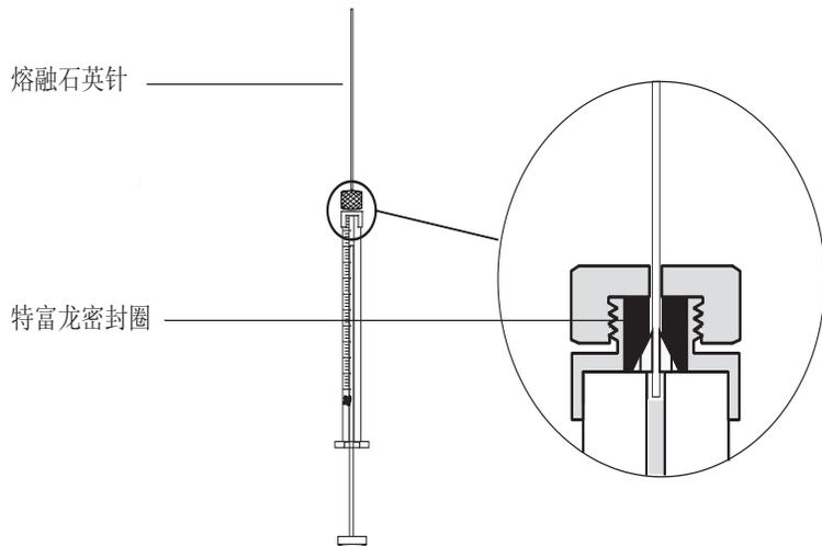
5 用手拧紧止动螺帽。轻轻地拉动石英针以确定聚四氟乙烯密封垫圈对针头已形成密封。如有必要，请进一步拧紧止动螺帽。
