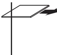
7 拿稳色谱柱，对色谱柱切割器（与刻线相对着）将色谱柱末端切割下来。使用放大镜检查切割端，确保其上没有毛刺或锯齿状边缘。
