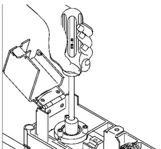
15 将喷嘴径直地拉出检测器。如有必要，可以用镊子。
