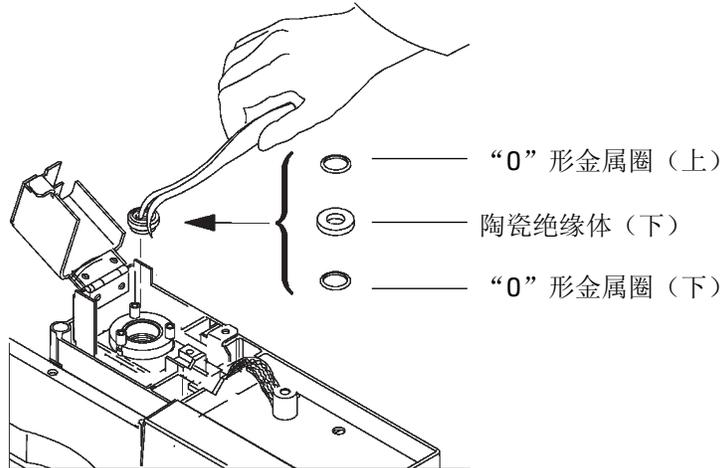
图6 NPD 陶瓷绝缘体（下）和“O”形金属环
