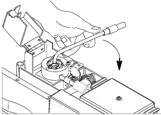
15 重新将铷珠组件电缆连接到 NPD 电缆并旋转环以锁定连接。
