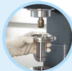
快速接口安装，极大缩短测量前后所需操作时间。
