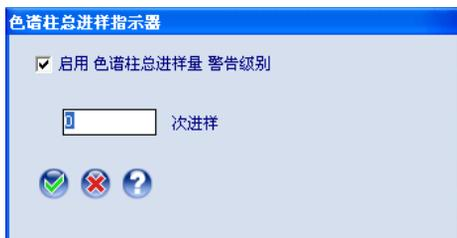
2. 单击“启用色谱柱总进样警告级别”框以启用或禁用色谱柱维护警告。
