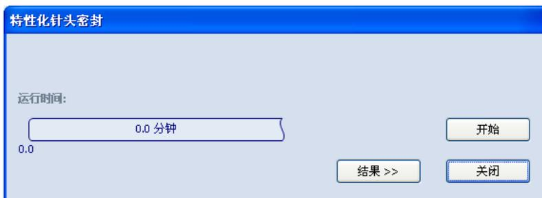
2. 单击“开始”。随即开始定性操作，样品管理器状态显示“定性密封”。当操作结束后，将出现“结果”窗格。如果定性不成功，检查针头以确保其正确安装。进行必要的调整，然后再次定性针头密封。如果不成功，请参阅本指南中的故障排除一节。
