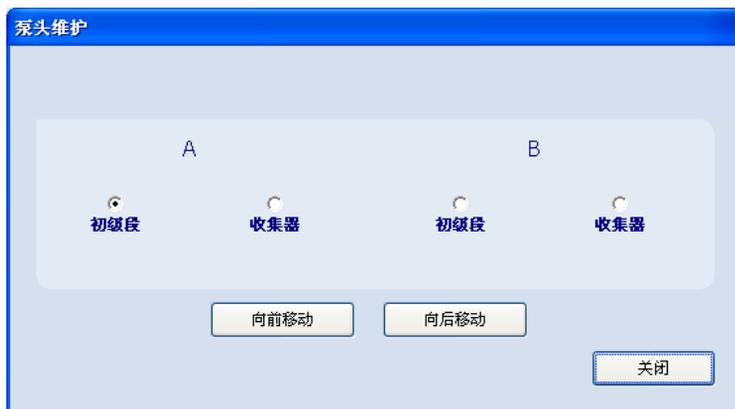
4. 在要对其执行维护的溶剂管理器（A 或 B）中选择泵头（“初级段”或“收集器”）。
