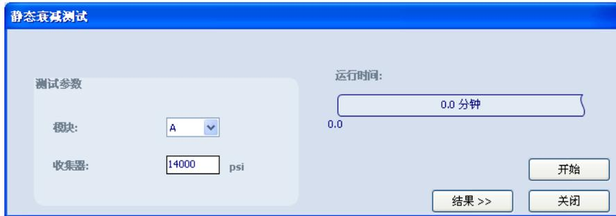
5. 在“测试参数”区中，选择要测试的模块（泵）。
