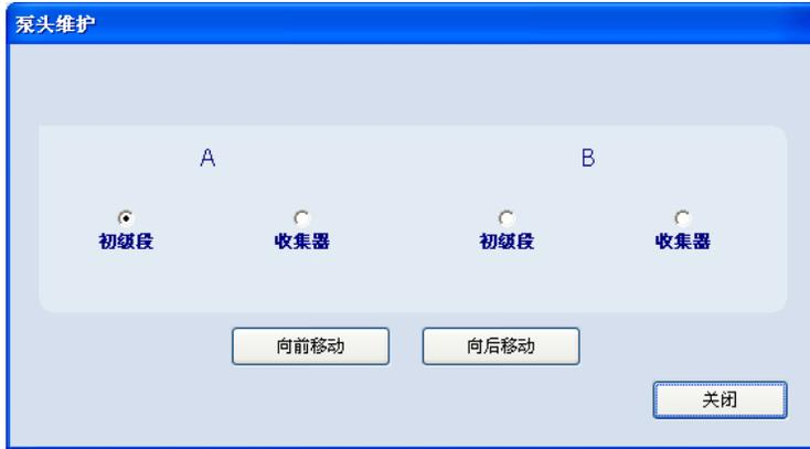
4. 在“泵头维护”对话框中，从要对其执行维护的溶剂管理器（A 或 B）中选择头（“初级段”或“收集器”）。
