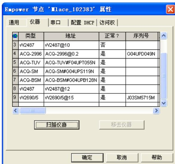
4. 确保二元溶剂管理器 (ACQ-BSM)、样品管理器 (ACQ-SM) 和检测器 (ACQ-TUV 或 ACQ-2996) 显示在仪器列表中，然后单击“确定”。
