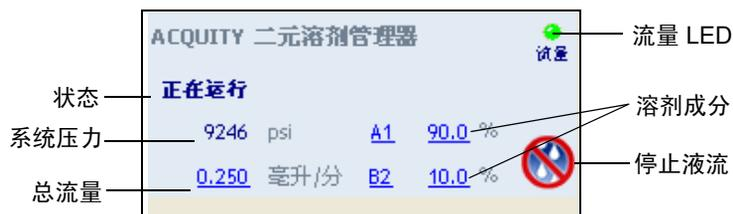
二元溶剂管理器控制面板可显示流量状态、系统压力、总流量和溶剂成分参数。系统空闲时，可以通过单击加有下划线的值编辑这些参数。系统处理样品时不能编辑二元溶剂管理器参数。
