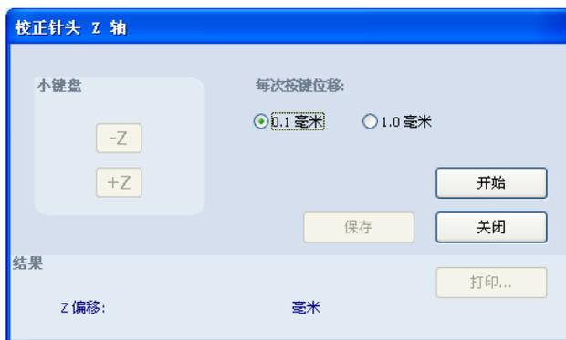
2. 在“校正针头 Z 轴”对话框中，单击“开始”，然后在确认窗口中单击“确定”。
