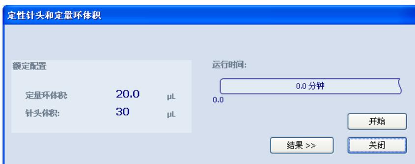
5. 在“定性针头和定量环体积”对话框中，单击“开始”。针头和定量环体积定性操作随即开始。当针头和定量环体积定性完成时，将出现“结果”窗格。如果定性不成功，确保正确灌注系统，然后再次定性针头和定量环体积。如果还不成功，请参阅第 7 章：诊断和故障排除。
