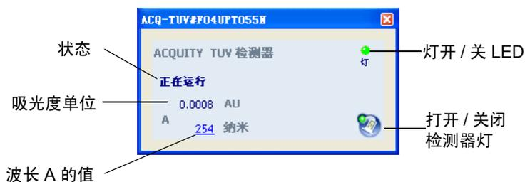
检测器控制面板可显示吸光度单位和波长值。系统空闲时，可以通过单击加有下划线的值编辑这些参数。系统处理样品时不能编辑检测器参数。
