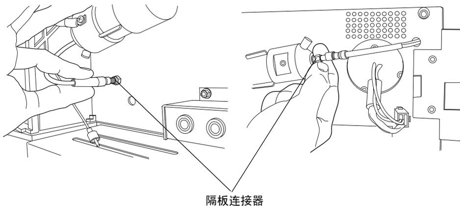
6. 从流动池装置上的金属接地接头断开接地线。
