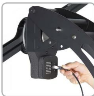
两轴测角仪使系统能够测量任何灯的完整 3D 分布区域
