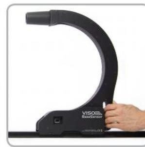
轻松连接测角仪的万向支架 测量前只需滑动并锁定到灯具中心
