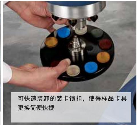
可快速装卸的装卡锁扣，使得样品卡具更换简便快捷
