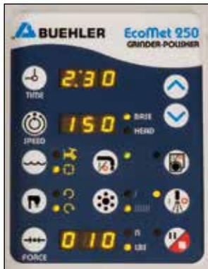
塑封薄膜回馈式按键，醒目的LED指示灯易于读取操作指令。
