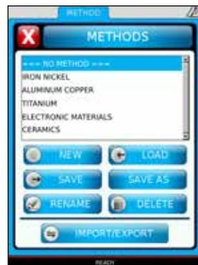
用户可以对特定的应用和材料，编辑和存储制备程序和方法，最多可以存储32种方法。
