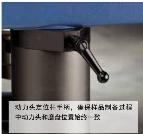
动力头定位杆手柄，确保样品制备过程中动力头和磨盘位置始终一致
