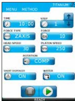
底盘和动力头文本模式界面，显示时间；加载力；速度；旋转方向；冷却水状态；滴液器状态；Z轴控制以及制备方法编辑/存储功能。
