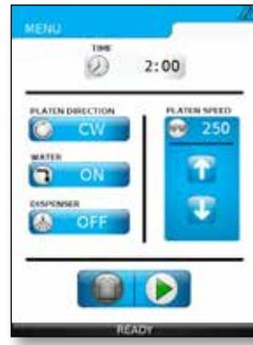
文本模式提供传统的按键外观，磨机设定界面实时显示控制磨盘转速，冷却水和滴液器状态。
