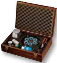
该附件主要用于印刷电路板上的镀铜通孔截面的样品制备。每次可以在卡具上的六个直径为1"(25mm)样品孔内放置样品，可同时制备多达36个样品。该附件可以精确控制材料去除速率，可制备直径为0.008"(200μm)通孔纵向截面样品，需要中心力驱动适配器（60-9000需要单独订购）。
