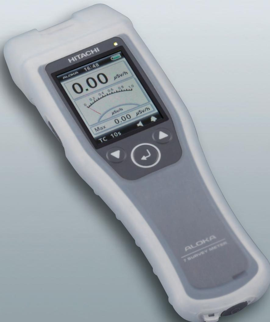
PDR-303是一款小型、以测量 $\gamma$ (X)射线空间剂量率为目的的巡测仪。由于采用半导体探测器以及具备了灰尘封闭防护喷水IP级别,加之操作简单,非常适合在各种恶劣的环境进行测量。另外,该设备采用彩色液晶显示器,使用者可以轻松读取测量数据。同时该设备还可以通过声音和显示对超过预设值进行报警。
