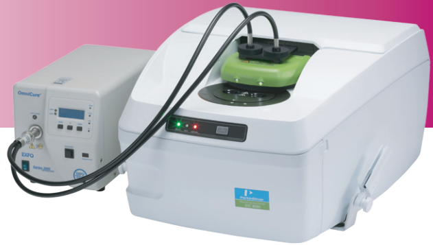
PerkinElmer DSC 8500与EXFO®UV固化系统联用设备
