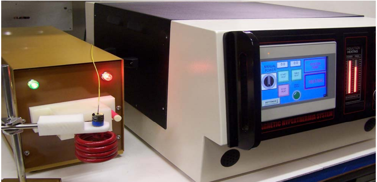
上图：试验探针和100nm颗粒正在被加热
