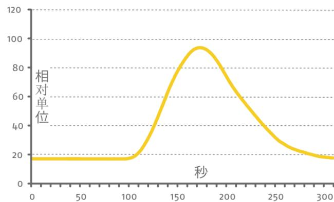
得益于卓越的低基线噪音和低漂移，即使是100 $\mu$ g/kg的硫(S)标准物分析也能获得可靠的检测结果。
