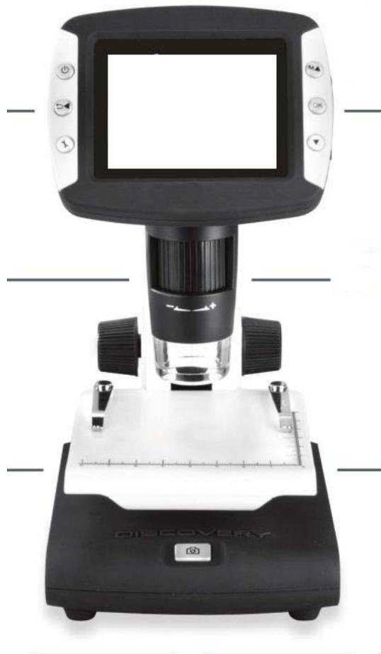
此数码显微镜可以与 PC, Mac and iPad (使用 iPad 照相机包为图像导入) 配套使用. 最大放大倍数为 1200 倍, 具备 LED 照明, 快拍, 拍摄和测量校准功能. 间隔拍摄的功能允许定时拍摄, 且照片最大可被放大到 1200 倍, 这个间隔拍摄记录功能能够很好的解决很多长时反应和变化过程的记录, 例如发霉过程和食物的腐烂过程。
