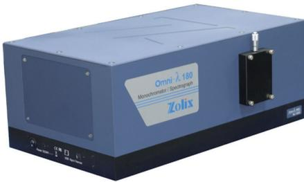
Omni-λ180D 是一款经过专门设计的一体化色散相减模式双级联单色仪，是 ZOLIX 的最新产品。对于色散相减模式的双单色仪，两级经过专门的匹配设计和光路调校，使得只有处于原始路径的光可以实现色散相消，最终会聚在出射狭缝处输出，有效降低杂散光。使用 Omni-λ180D 双单色仪，能够获得更为纯净的单色光，从而满足微弱信号测试需求，如拉曼光谱、光电探测器光谱响应度标定等。
