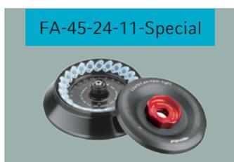
气密性固定角转, 容量 24 × 1.5/2.0 mL, 独有 PTFE 涂层, 可进行苯酚、氯仿等强腐蚀性样品的离心, 最大相对离心力高达 20,238 × g
