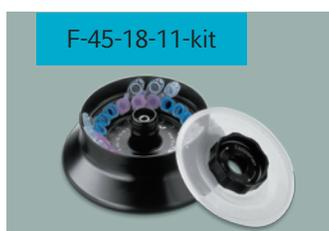
Eppendorf Kit 转子, 最大相对离心力为 17,347 × g, 适用于 18 × spin columns 管或 18 × 1.5/2.0 mL 离心管。独有加宽的边缘, 防止开盖离心时, 意外打掉管盖
