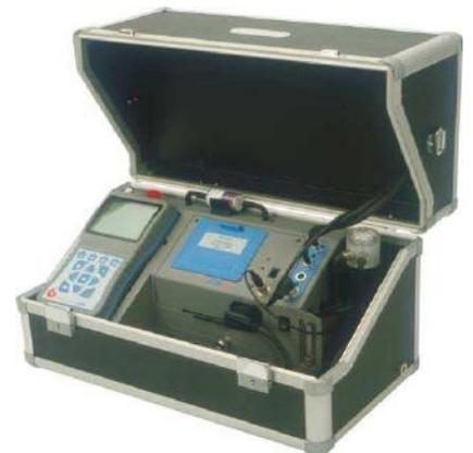
量组件的基础单元直接安装在测量点（烟气管道），移动控制模块用来调式锅炉或仪器组件检查。
