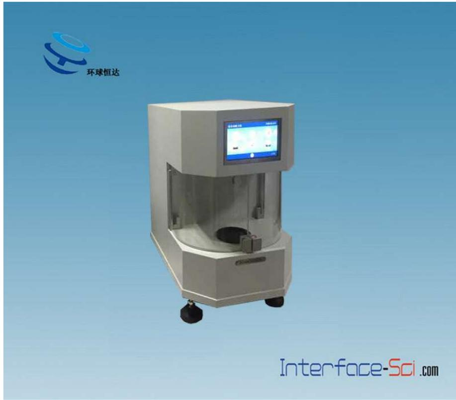
JK99F 型表面张力仪符合 SY/T5370-1999 表面张力及界面张力测定方法行业标准。界面张力：液体与另一种不相混溶的液体接触，其界面产生的力叫液相与液相间的界面张力，通常把液相—气相之间的张力称为表面张力，例 20℃时水的表面张力是 72.75，就是指水与空气界面上的表面张力。我们又把液相—液相之间的张力称为界面张力。测量方法主要铂金板法、铂金环法，应用领域：三次采油（化学驱）的室内研究及现场监测；表面活性剂、洗涤剂、乳状液和泡沫研究；燃料油、润滑剂、油漆、油墨及涂料研究；农药等方面研究等。
