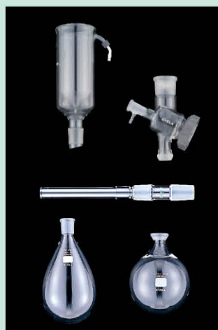
T(广口瓶冷凝管)型 玻璃件广口瓶型冷凝器内可以放入冰、干冰、丙酮，适用于低沸点物质的回收。可以与接收瓶用冷却水浴槽组合使用进行回收。
