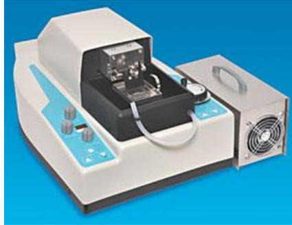
为新型独特的线性电机系统，可得到更薄、损伤更小的切片，使用寿命更长
