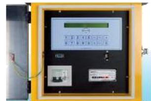
显示和记录采样时间，采样体积和所有信号。流量计算、采样平均温度、标态体积度。
