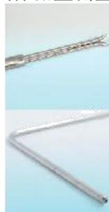
“S”皮托管是由不锈钢制成，带一个“K”热电偶测量温度，外管的直径为 25 毫米。
