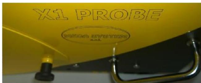
X1 - PROBE 是目前唯一市售的探头，在加热管中包括采样管，测量管（皮托管热电偶）和一个独立的气体采样管
