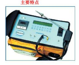
聚碳酸酯键盘\大背光 LCD 显示器 计算符合 UNI 10389 标准
