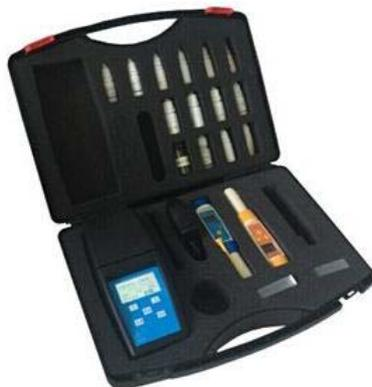
在水产养殖中，溶解氧和适当的PH值及盐度是必不可少的条件。而氨氮、亚硝氮及硫化氢是鱼虾代谢所产生的主要有毒物质。准确及时的测量这些物质的浓度值，然后采取相应的措施可大大提高鱼虾的成活率，降低养殖成本。该仪器内部由嵌入式为电脑控制，自动测量，采用汉字菜单方式，按键少、操作简单直观，未经培训的人员也可迅速掌握仪器的使用方法。它采用特制的密封专用比色管达到方便快捷测定水质的目的。在仪器中采用冷光源窄带干涉滤光技术，仪器采用铝合金外壳，结构紧凑，没有可动部件，坚固耐用，不易损坏，适合淡、海水现场测量。使之成为新一代智能多功能仪器。能满足各种江河湖泊海洋的养殖测量需要。是现代水产养殖监测与管理理想的专用仪器之一。
