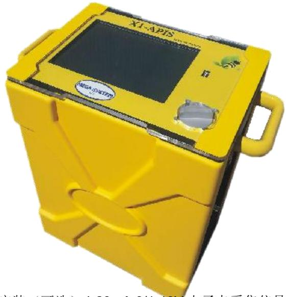
可安装（可选）4-20mA 0/1-10V 电子卡采集信号使仪器获取和保存来自他品牌制造商生产的废气分析仪的采样报告得到的参数参数计算气体密度、含湿量；实时计算调节等速流速。
