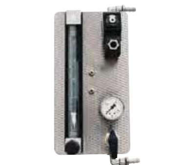
不易燃保护或反应气体的充气系统, 配有闭塞栓和带调节阀的流量计, 管 路已排好
