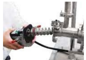
转速可调节式螺旋输送机
