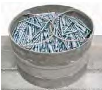
采用水蒸气在一个 NRA 系列的炉内对钻头进行蓝化处理
