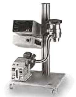
真空泵工作站的最终压力可达10 -5 mbar
