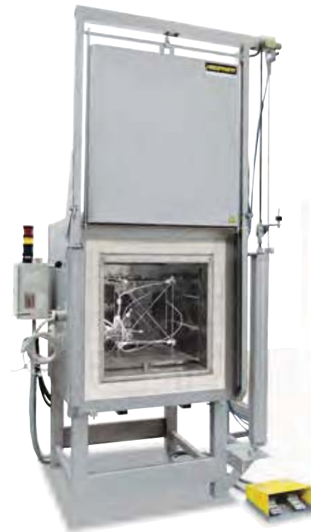
用来测量温度均匀性的测量架
