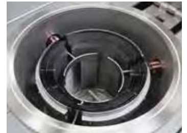
带钨丝加热装置的圆柱形气密罐
