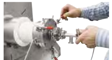
水冷末端法兰，快速连接装置作为额外配置
