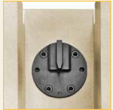
冲击测试配置。试样水平倚靠在夏比支撑上（包覆着保护布）。在前方可以看到夏比对中钳。右图为摆锤。
