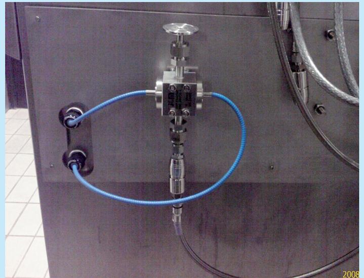
图 2 & 3：安装移动CIP分析仪的RVP流通池用于旁路操作
