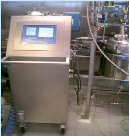
图 3 : 典型移动CIP处理分析仪 J&M 探测器内部
