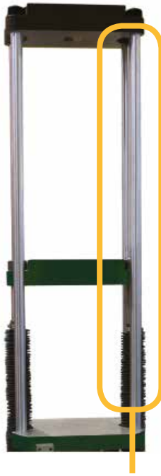
此款150SL机架为加高型，能够装载大型样品。
