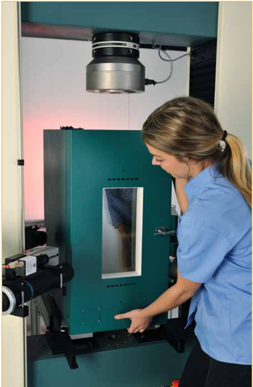
图1. 环境箱可以很容易的通过一个轨道系统移至所需位置
