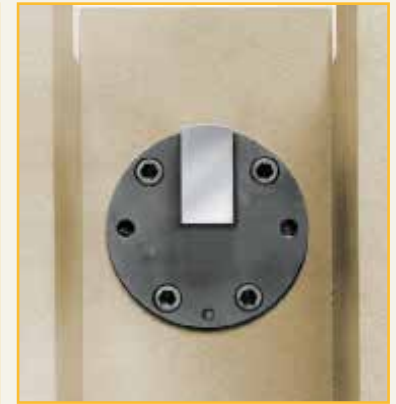
悬臂梁式冲击测试配置。试样竖立，一端通过前螺纹/钳口夹持。右图为摆锤。
