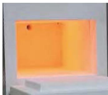
马弗炉胆四面加热
