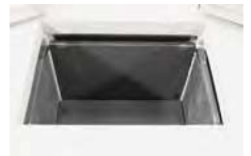
S 73/HS的炉膛衬装SiC板
