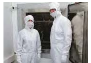
N 250/65 HAC 型循环空气炉，级别为100的无菌室结构型式，炉门位于无菌室内
