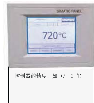
控制器，热电偶和有效加热区的误差总和为系统精度
