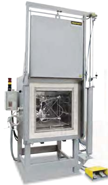
用来测量温度均匀性的测量架
