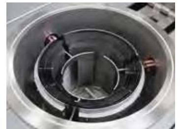
带钨丝加热装置的圆柱形气密罐
