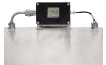
光学温度测量, 用作连续炉
