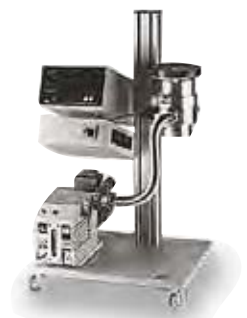
真空泵工作站的最终压力可达10 -5 mbar
