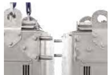
用于连接两半炉体的铰链螺栓
