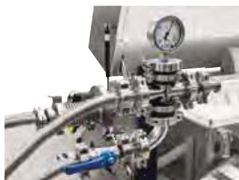
用于真空操作的连接件
