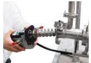
转速可调节式螺旋输送机
