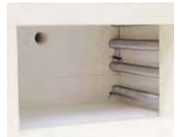
炉腔具备高级轻质耐火砖保温结构
