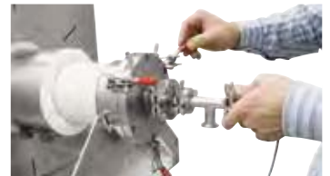
水冷末端法兰，快速连接装置作为额外配置
