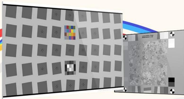
Imatest专业测试软件，配合各种不同类型的测试图卡，能够针对图像的分辨率，色差，畸变，噪声，灰阶，动态范围，鱼眼效果，闪光，色彩准确度等等进行定量的分析。这些测试卡都是根据图像质量测试标准来设计的。多数测试卡具有同时进行多方面测量的能力。而针对色差，动态范围等，也有专门的测试卡来进行更加准确的分析。
