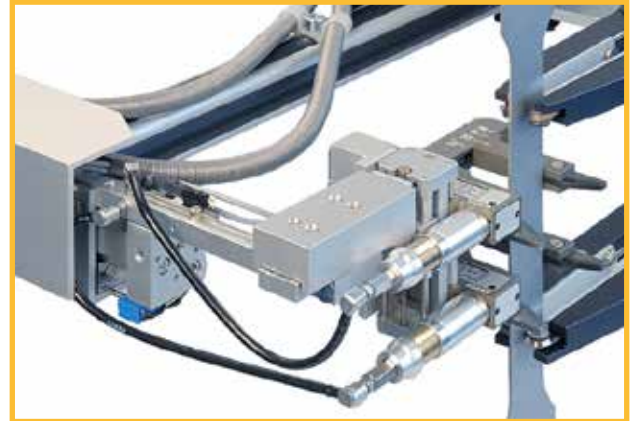
AE300上的跟随测量臂和试样上的横向AE引伸计特写。
