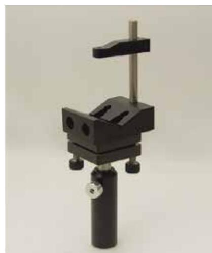
V型夹具不仅可固定大直径的圆柱型透镜，如激光束，也通过一组螺钉固定光学件在夹具上。该元件可与18RCP系列支撑棒和18LSR系列支撑棒配合组装，可进行水平和垂直的高度调整。如果与15PRT-4连接，倾斜可调。
