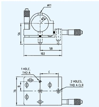
当需要直接位置读数时，精密激光装置 16LMP系列会很有用。为了使正交轴有  $\pm 4^\circ$  的调节范围，我们使用了两个独立的精密分厘卡。使用尼龙头螺钉，以防止在安装过程中激光管有偏摆。
