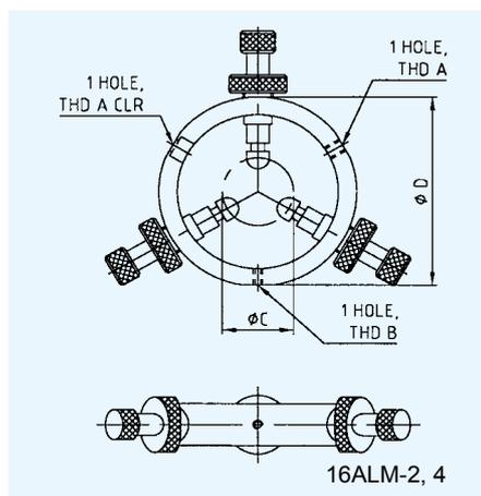
两用安装螺钉用于定位透镜和微调透镜。透镜快速安装，高精度对准。一个活动轴可被锁定，以确保镜头的重复性位置精度。透镜安装后，微调螺钉进行调整。
