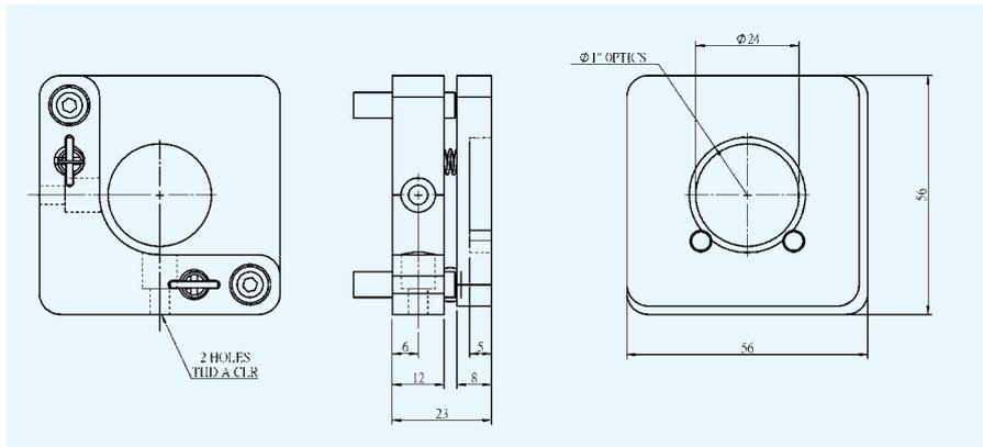
16UPM-1(M)-H型号各方面高精度加工确保了高精度位置调整的稳定性。特殊材料的精密设计保证了高重复性和耐久性。蓝宝石座防止球尖调整螺钉的磨损。螺钉把手可以拆卸。
