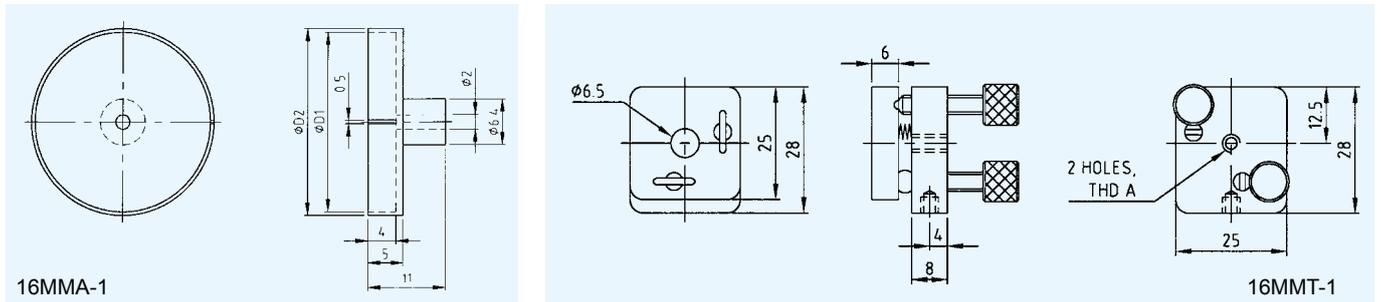
通过一个易于安装的光学适配器，一个实用的棱镜可以转化成适合于1英寸（25mm）前表面反射镜的稳定的支架平台。两个独立的#8-80精密螺丝在该微型镜架上产生倾斜以使光线对齐。
