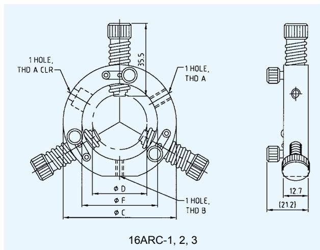
通过这些夹具，可以快速安全紧固圆形元件如透镜，反射镜，或激光管等。螺钉尖端有非旋转式V型槽，可粗调螺纹以保证快速操作。
