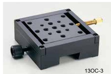
滑座采用相反的燕尾结构设计，与130C系列滑轨配合使用。螺钉紧锁后滑座的平面度可以得到保证。滑座可以安装在滑轨的任意位置处。通过螺钉的松紧调整可快速的定位滑座。为了满足特殊的需求，提供了三种不同的型号。130C型号滑座的垂直精度最多可以调整到10mm。
