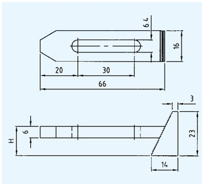
这种万能压板可以固定不同厚度的底座（工件）。使用一个单独的螺钉可固定压板在任意高度上。锯齿形棱柱调整压板的高度从3mm到20mm，锯齿增量为1mm。
