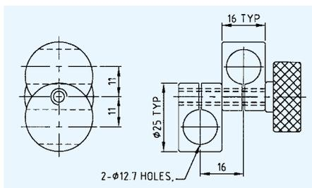
一个螺钉同时固定两根接杆。任何角度固定都可以保证杆架的平面度。在保证杆架的平面度的同时可在任何一个角度固定两根杆架。
