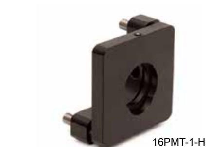
16PMT-1(M)-H型镜架各方面高精度加工，确保了高精度位置调整的稳定性。大载荷弹簧的高精度设计保证了高重复性和耐久性。使用两个不锈钢销，调节平稳并降低了成本。六角设计节省空间。六角扳手或一个可拆卸18SRN-1型旋钮用于调整。
