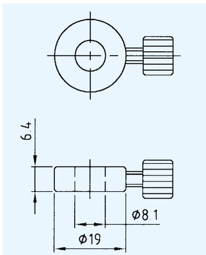
\* 10HFC-1定位夹可使接杆在固定高度旋转调整
