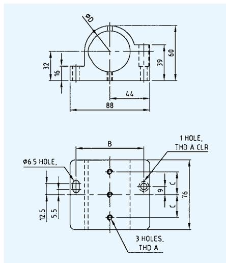
16LMS系列提供简单而稳定的方式安装激光管或其他圆柱形物体到光学表面上。一个尖尼龙固定螺钉防止激光器摇晃。
