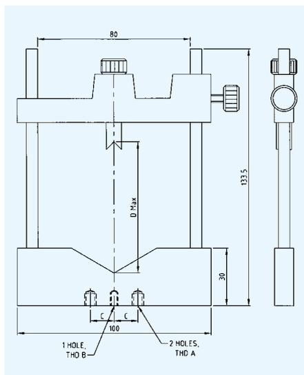
可调镜架易于配合使用1/4-20(M6)和8-32(M4)螺纹接杆系统。顶部V型夹头可夹持直径从0.5英寸(13毫米)到3英寸(76.2毫米)的光学元件。04VLH-3型使用V型槽底座快速定位光学元件中心位置。
