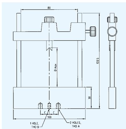
柱面镜架易于配合使用1/4-20(M6)和8-32(M4)螺纹接杆系统。顶部V型夹头可夹持长达3英寸(76.2毫米)柱面镜。
