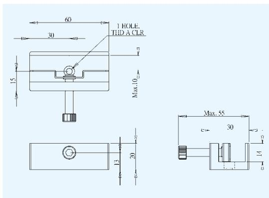
16PHF-1夹板结构简单，可夹持厚度达10毫米元件。弹簧带牢固支撑，耐摩擦垫防止平板划伤。
