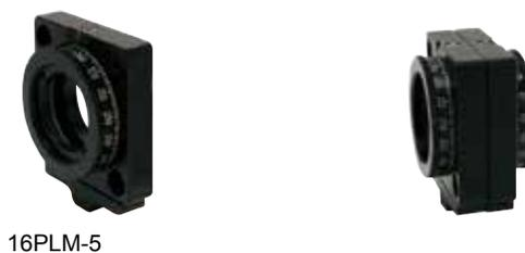
16PLM-5型和16PLM系列有着相同的特性，但是设计成正方形外型。360度激光标刻，两个精度增量，可重复定位和角度细微调整。一端的读数遵循空间应用标准。使用六角扳手安装一组旋转螺钉。方形的框架易于与其他元件连接。配合其他元件分别独立控制旋转。
