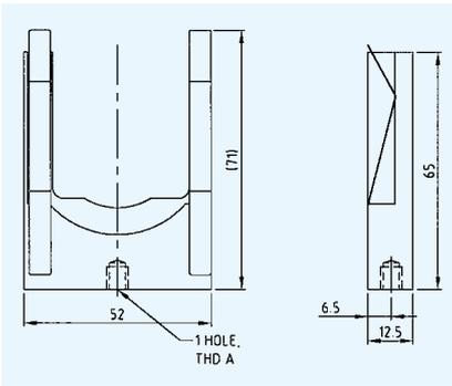
滑动背后的不锈钢弹簧夹，可立即固紧滤波片和检测目标。通过平板背面和直角边的垂直关系，确保重复对正。底部螺纹孔设计满足多功能应用。
