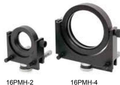
通过有间隙的金属件紧固定位圆形镜或分光镜。当镜子或分光镜安装好后，可粗调或微调仰角。此外，当系统在固定方位安装元件时，可以调整元件的任意仰角。
