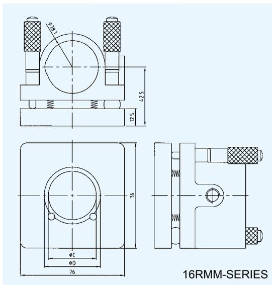
镜片被固定在一个坚固的支架上，这个支架有若干尺寸的通孔。此镜架的基础部分连接到一个1.5英寸（38mm）的支撑棒上（单独销售，如18LSR-1型），以提供垂直于底板和相对于支撑棒任意角度的位置。用手指将镜片装入配件中。配件可以在两个方向上微调以实现精确控制。
