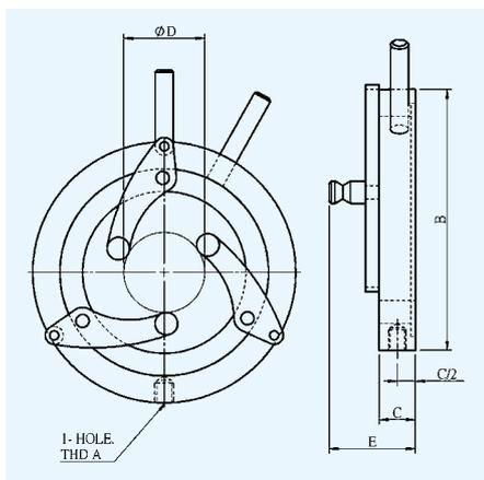
任何小于透镜座最大内径的透镜可方便精确安装，透镜中心不变。通过抓放外侧支架上两个外翼可快速松开三爪卡盘。透镜定位后，手柄上弹簧爪可以固定好透镜。
