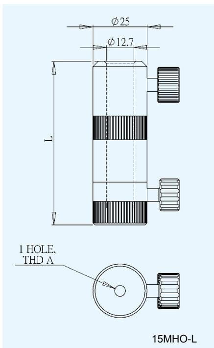
该系列杆架通过底端螺纹孔与底座、平台或面包板连接。所有杆架都配有定位弹簧螺钉。各式杆架和不同高度接杆配合使用, 可达到所需高度。
