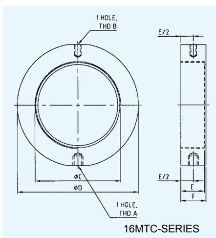
16MTC系列用螺纹压圈固紧光学元件，并可以安装在8-32 (M4)或1/4-20 (M6)的螺纹接杆上。
