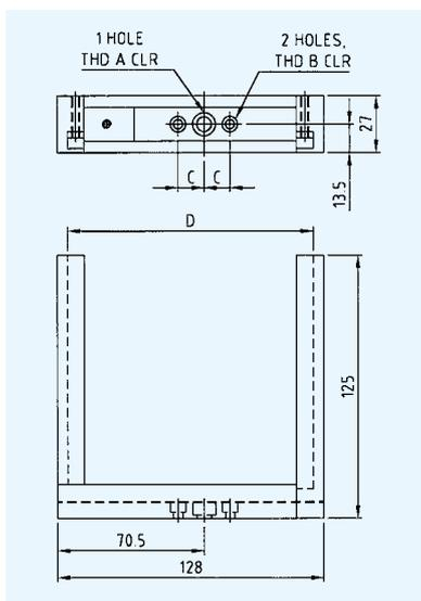
该型号为固定方形光学元件，设计简单。顶端滑动定位，便于快速操作处理。高加工精度。
