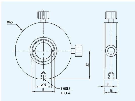
光学定位器是实验时需要中心调节的理想工具。该定位器提供一个三点聚甲醛螺纹压圈牢固光学件，无磨损。另一个三点聚甲醛压圈在另一端保护光学件。
