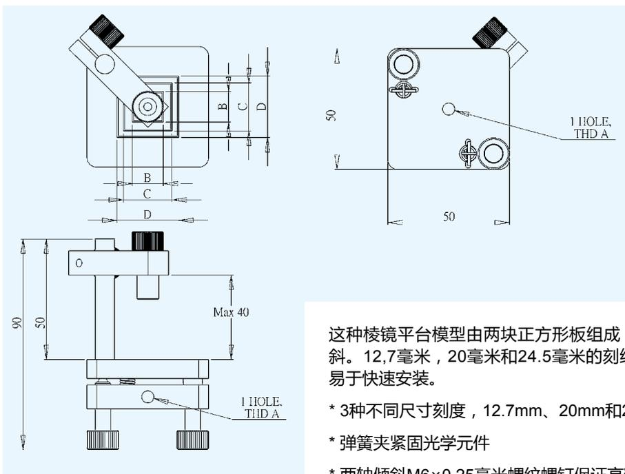
这种棱镜平台模型由两块正方形板组成，通过两个M6×0.25毫米螺钉精确调整2轴倾斜。12.7毫米，20毫米和24.5毫米的刻线可使棱镜、立方体、分光镜和其他立体元件易于快速安装。
