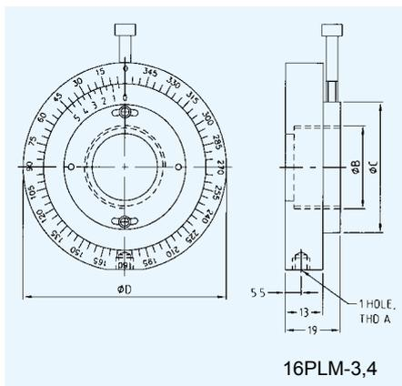
标准尺寸的偏振片与光轴垂直安装。内部安装圆柱可以自由旋转到任意角度。测量精度0.5度。
