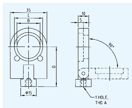
这种折叠式光学镜架可以收起，以便让光学元件位于或偏离光束而不产生在实验中多路激光复用棘手的情况。光开关和光束路径选择器也可以应用在平面镜安装中。高重复性和快速定位要归功于球型接头自我定位的设计。光学元件使用三点聚甲醛垫无头六角螺钉尖端固定，防止损坏。
