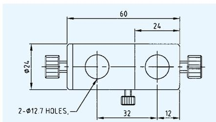
两根接杆所在平面保持平行。可360°相对转动。在不影响光学系统其它元件的前提下，固定分离装置可使两根接杆精确准直或固定在任意相对角度。
