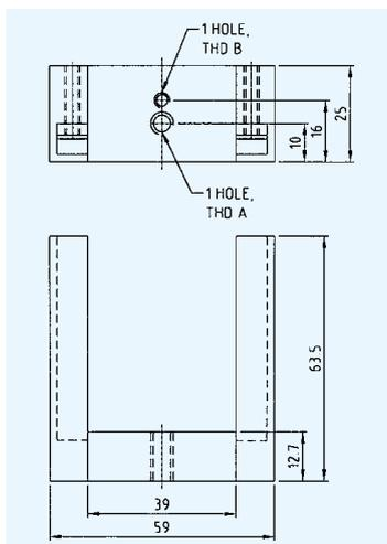
该型号为固定方形光学元件，设计简单。顶端滑动定位，便于快速操作处理。高加工精度和可调弹簧保证设备的光轴垂直。
