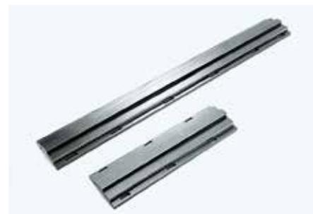
铝合金材料精密加工的滑轨为器件的安装提供了精密和稳定的平台。滑轨上的燕尾座可以快速容易地与滑动座上的平行和平面位置配合。滑座之间的距离可由滑轨两边的公制标尺准确的表示出来。对称设计可使滑座放置于滑轨的两个方向。线性度控制在 $\pm 0.2\text{mm/m}$ 内。
