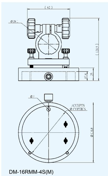
该系列挂杆式镜架16RMM-4S(M)为4英寸（101.6mm）直径的镜片提供可变的垂直位置。这个镜架兼容英制和公制大型架杆。此镜架使用两个M6x0.25mm螺距螺杆驱动器来固定镜片的位置，同时提供±4°的正交调整范围。背面有一个接口，可以快速简单的取出镜片，镜片可以通过尖端有尼龙的翼型螺钉紧密固定。
