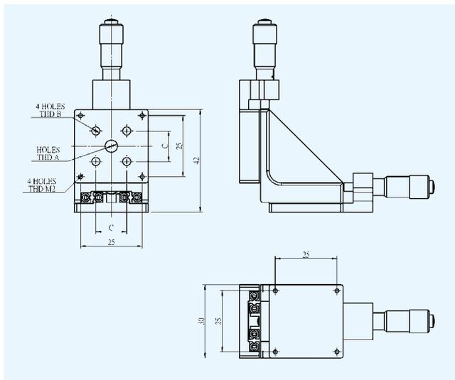
紧凑的结构和微调设计使位移台可以运用到有限的空间里。交叉轴承的设计获得了更高的精度，并保证轴上的线性移动。该模型是Y&Z轴位移台，最多可读到0.01mm。
