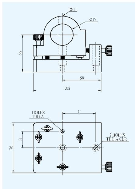
16LMR系列高精度激光架同时考虑低成本和倾斜度调整。两个独立的高精度螺钉防止安装过程中激光管摇晃。
