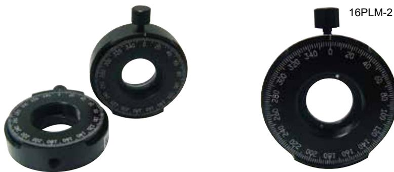
16PLM-2(M)型旋转架采用光滑旋转环形轨道。中心孔径适用于1"直径光学元件如偏振片，波片，螺纹压圈定位。360度激光标记前面板有2度的增量，允许重复定位和角度调整。顶部螺钉通过旋转锁定定位。最大光学厚度为0.28"（7毫米）。
