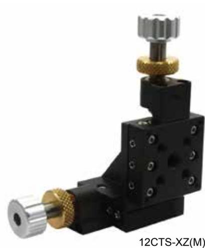
紧凑的结构和微调设计使位移台可以运用到有限的空间里。交叉轴承的设计获得了更高的精度，并保证轴上的线性移动。模型提供有紧锁螺母。X&Z轴模型为标准模型，用户可根据需求定制其它轴的位移台。
