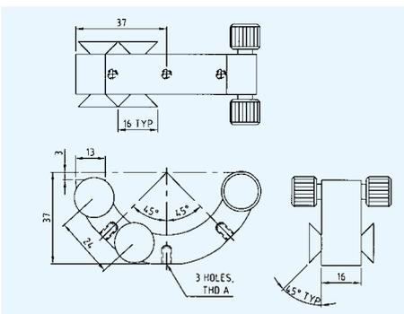
这种滤波片固定座为方形和圆形滤波片而设计的。滤波片通过简单的设置可立即安装到位。燕尾销用于调校。另外，两滤波片可以分别独立工作。对于双滤波片无接触安装，避免潜在刮伤的可能性。敞开式设计保证了工作光最小影响。
