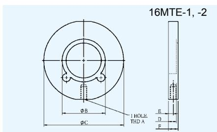
16MTE型号的低成本镜架可以十分方便的用在螺纹接杆系统中，固定直径为0.5、1或2英寸的光学元件。
