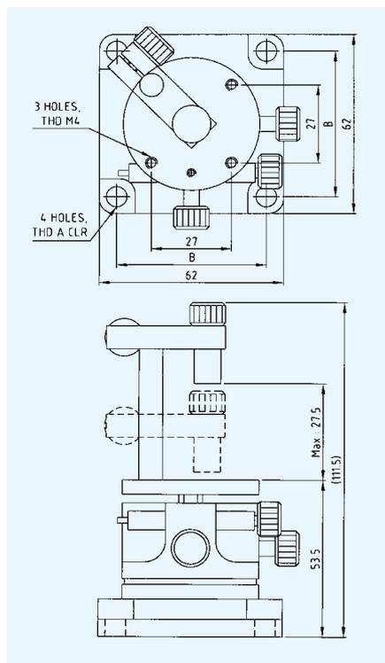
15PRT-3(M)型倾斜/旋转棱镜台可在倾斜和水平方向独立 $\pm 3^\circ$ 内调节。棱镜台通过弹簧夹和顶板上的螺纹孔紧固光学元件。底座四角的1/4-20(M6)通孔保证了在光学表面紧固棱镜台。
