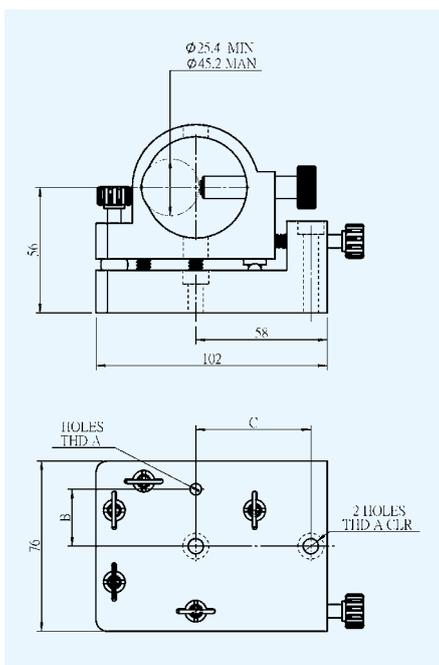
可调激光/圆柱体底座 16LMR-4A 通过一个稳定的三点设计为激光头和其他圆柱体物体提供无漂移指向。我们的 16LMR-4A 适应性最好，它实际上是 16LMR-1~4 产品的组合。换句话说，16LMR-4A 有直径 1 至 1.75 英寸 (25.4 - 45mm) 的圆柱激光头，能准确的固定，并通过两个 M6x0.25mm 螺距螺钉进行  $\pm 4^\circ$  的精确角度调整。通过推动尼龙翼形螺钉与 V 型槽接触，16LMR-4A 能使激光头或圆柱体底座安装时无偏摆。两个通孔可以通过其他光学机械部件例如杆夹持器 18RCP -1 和支撑棒 18LSR-1 可以与光学平台、面包板或支架连接。
