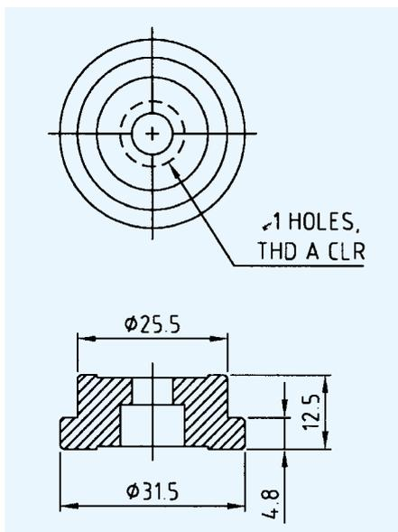
比常见接杆/杆架系统有着更大直径的底座，为光学元件安装提供了更好的稳定性。
