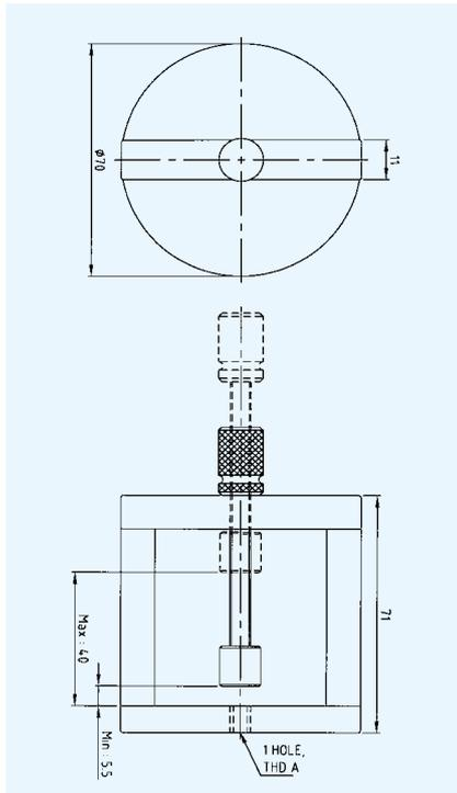
15PRT-1型简易棱镜台，最大高度为40毫米的棱镜、分光镜和其他元件。棱镜台通过底座上1/4-20(M6)螺纹孔易与带螺纹的光学平台连接。通过安装夹定位棱镜、分光镜和其他光学元件。
