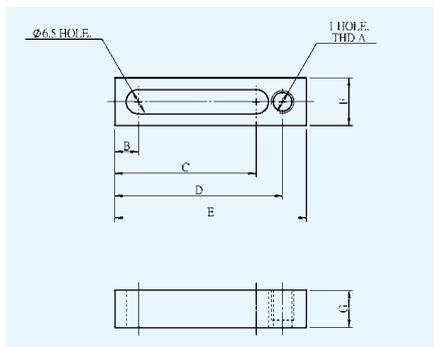
可调式压板可灵活固定那些不能直接固定在螺纹表面的光学元件。可调式螺孔和螺钉可在平面上固定住不同厚度的底座。可使用英制螺纹和公制螺纹。
