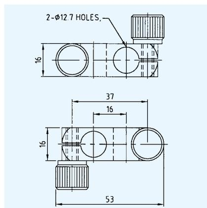
滚花螺钉紧固90°正交接杆。锁紧手轮稳定定位，阻止接杆轴向和径向滑动。
