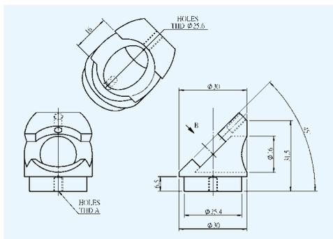
我们的45°光学座兼容所有Ø1" (Ø25.4 mm) 光学器件例如镜片和分光镜，并且通过尼龙头螺丝将它们固定到位。该光学座中部有一个通孔，支持分光镜的使用。该镜架还适合可倾斜1"的镜架，用来对从垂直方向到原始方向的光线提供可变校准。
