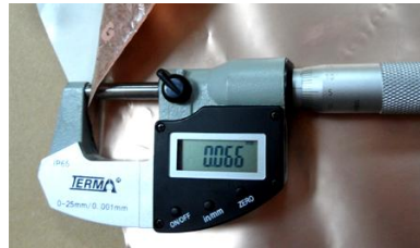
铜箔+导电胶总厚 0.066mm (0.05~0.07mm)
