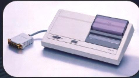
这些小热敏打印机连接每个Zeta系列型号都有的标准RS232数据接口。每个打印机包括连接电缆和很好记录你的阅读记录以便日后查看。
