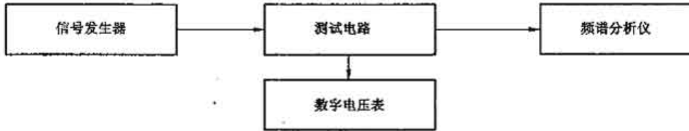
图 12 零偏压电容测试方框图
