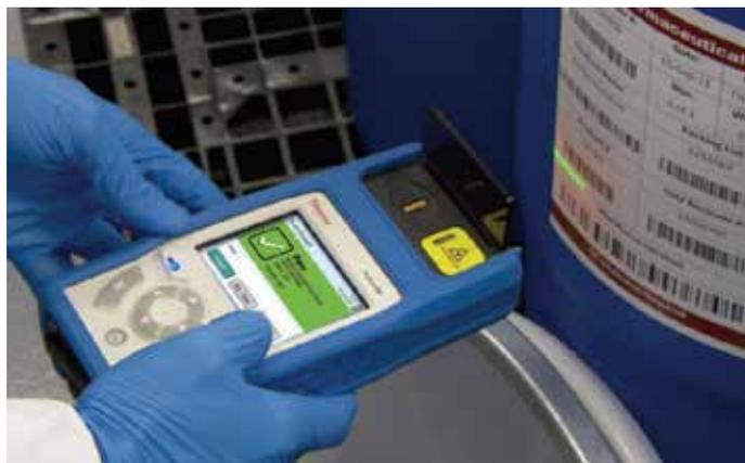
分析仪的自适应决策工具不需要手动设置阈值或方法维护即可轻易区分物料。内置决策工具不仅采集样品光谱，也测量分析时的不确定度，进而针对不同的潜在干扰（例如：光线，温度和操作者的用法）自动调整分析仪到合适的采集参数。
