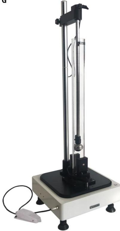
LQ-50 落球冲击试验机，主要适用于有机材料制成的汽车内外构件，例如板件、薄膜、衬里、柱装饰板、防擦板等等。是依据大众汽车集团标准中，《PV3905 有机材料：落球试验》《PV3966 PP 组件；应力发白性能（落球试验）》，两个标准测试要求定制的一款落球冲击试验机。
