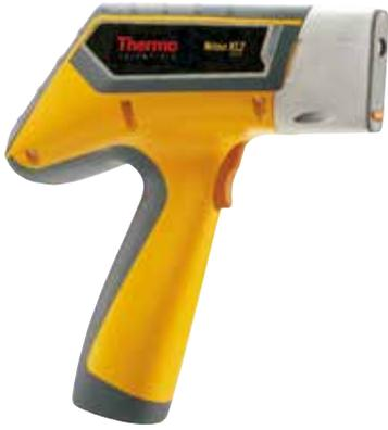
Niton XL2 GOLDD: 大面积硅漂移探测器 and 优化的几何结构适用于更多的 X 射线计数, 读数更快更精确。
