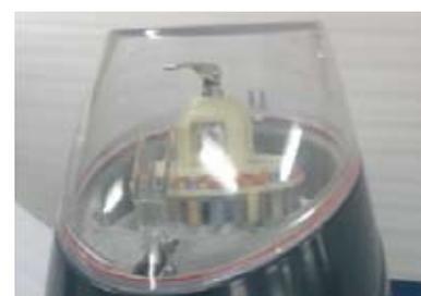
圆顶锁系统包含一个可以通过触摸屏操作的电-机械锁
