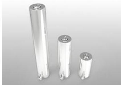
AU-NPS-15L 是高荷载大推力的压电陶瓷促动器。该促动器内置电容位移传感器,在全 15 $\mu\text{m}$  行程中分辨率可达到亚纳米级别,迟滞性<0.02%,直线误差为<0.01%。采用不胀钢材质及特殊的设计,具有极低的热漂移和高的刚度,因此具有极高的稳定性和高的负载,其最大负载可达到 15kg。采用独特的优化机械设计,空载自振频率可到达 8000Hz。
