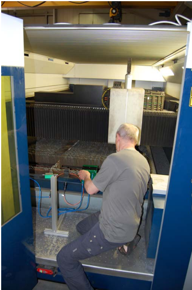
Figure 6: 在加工舱内安装积分球和光功率计
