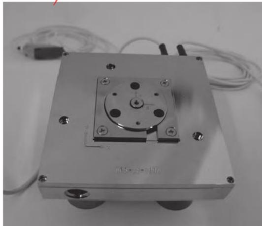
**AU-NPS-XYZ-100/Z15H** 由 AU-NPS-XY-100A 和 AU-NPS-Z-15H 组合而成，因此这款三维扫描台性能与上一款性能相似。不同的是 AU-NPS-Z-15H 平台为中空的。
