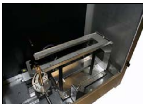
水平燃烧支架
