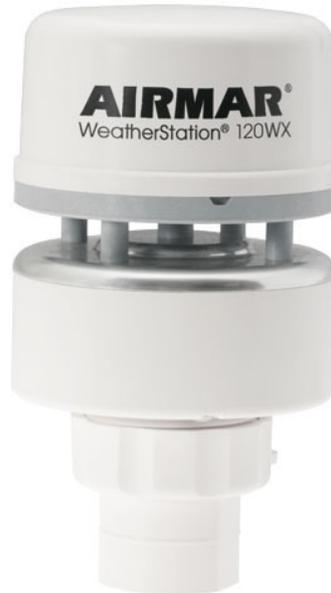
美国 AirMar 120WX 超声波气象仪是一款结构紧凑的气象测量仪器，是 110WX 的升级产品，适合海洋塔台、钻井平台、港口等的固定安装使用。可选相对湿度传感器，具有 RS232、RS422 和 CAN BUS 数字输出，输出格式同时包括 NMEA0183 和 NMEA2000，可满足多种气象监测的需求。
