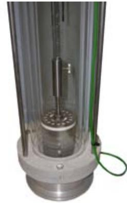
▲ 高温耐腐蚀燃烧筒：燃烧筒的耐热性直接影响燃烧筒内温度均匀性。
