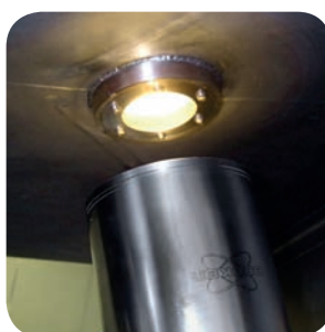
探头可连接到各种反应器的视窗。
