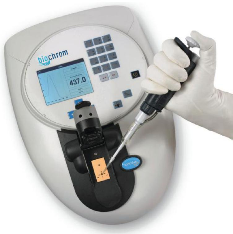
NanoVue Plus 分光光度计展示点样、测量和读数。用移液器直接将样品点到点样板上测量。点样板可简单快速擦净
