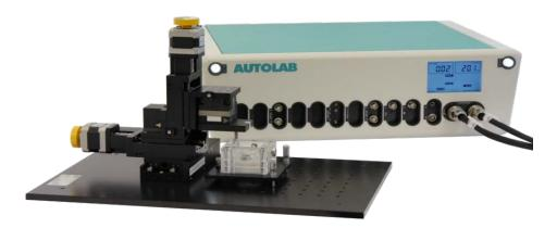
Base-SECM / PGSTAT302N 是一台高性能扫描电化学显微镜,整个系统包括四个主要部分:高精度步进系统,PGSTAT302N 双恒电位仪、专用电解池和 CCD 成像系统。
