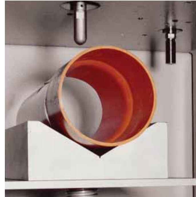
针对管道试验的 V 形块支撑夹具
