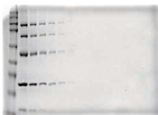
样品：两倍系列稀释的LMW分子量标准 后染色：考马斯亮蓝 成像：Amersham Imager 600 成像方法：比色白光透射 检测限：16ng的碳酸酐酶 Carbonic anhydrase
